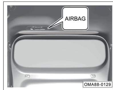
Подушка безопасности для заднего стекла установлена в задней части крыши (темная зона, выделенная пунктиром). Надпись AIRBAG означает наличие подушек безопасности.
