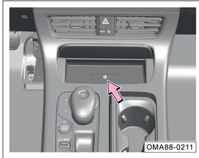
После включения системы беспроводной зарядки мобильного телефона, ее статус будет меняться в зависимости от использования. При нажатии на иконку появится соответствующее текстовое сообщение.
