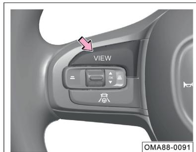
Когда выключатель зажигания находится в режиме ON, тему дисплея можно изменить нажатием на кнопку VIEW с левой стороны рулевого колеса.
