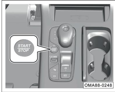
Выключатель зажигания (кнопка START STOP) срабатывает только после обнаружения дистанционного смарт-ключа непосредственно в салоне автомобиля.
