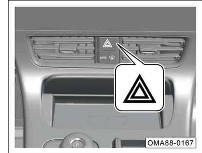
При любом положении питания автомобиля нажмите переключатель
