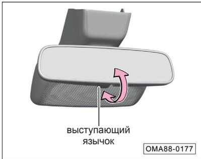
Ручная регулировка внутреннего зеркала заднего вида может уменьшить отражение света, исходящего сзади, обеспечивая оптимальное состояние обзора сзади.
