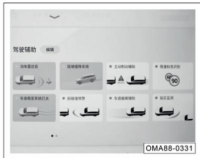
Когда автомобиль находится в движении, система поддержания курсовой устойчивости включена по умолчанию. Войдите в интерфейс мультимедийной системы и нажмите на кнопку панели управления вождением в нижней части панели инструментов . Войдите в панель управления водителем и нажмите на кнопку «Система курсовой устойчивости», чтобы отключить ESP (только TCS), при этом загорится индикатор на комбинации приборов и появится предупреждающее сообщение.
