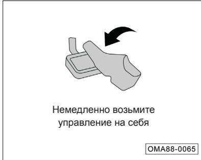
Система ICA обеспечивает ограниченное тормозное усилие и иногда торможение может потребовать участия водителя. В этом случае на дисплее комбинации приборов появится предупреждающее сообщение и раздастся звуковой сигнал.
