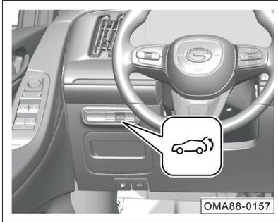
Долгое нажатие на кнопку задней двери на приборной панели разблокирует заднюю дверь.
