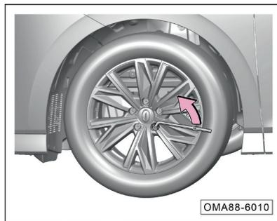
Ослабьте болты, плотно фиксируя на них ключ и вращая его против часовой стрелки.
