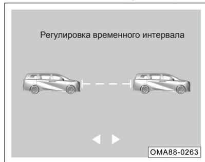
После переключения электропитания автомобиля в режим ON, расстояние до автомобиля впереди при активной системе будет соответствовать последней запомненной передаче (на четвертой передаче расстояние максимально).
