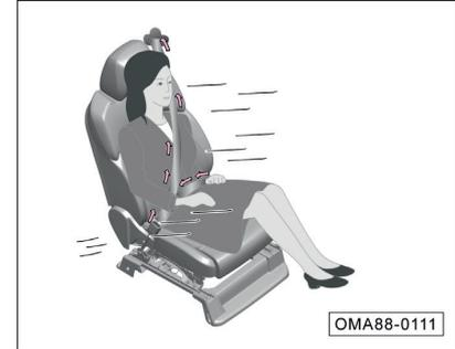
Ограничитель усилия предварительного натяжения ремня безопасности позволяет снизить давление на грудь пристегнутого человека при аварии и улучшить защитные характеристики ремня безопасности.
