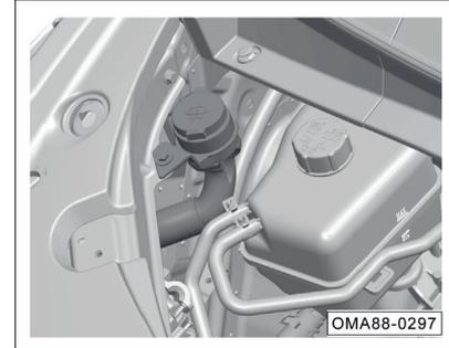
При обнаружении слишком низкого уровня жидкости стеклоомывателя необходимо своевременно долить жидкость стеклоомывателя в бачок стеклоомывателя.
