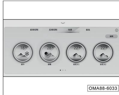
Откройте интерфейс управления системой климат-контроля на дисплее мультимедийной системы и нажмите кнопку «Программы», чтобы перейти в окно управления программами системы климат-контроля.
