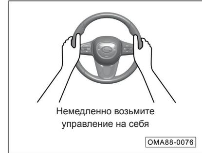
Если система обнаруживает, что водитель долгое время не держит руки на руле, система выдает предупреждение, на приборной панели отображается соответствующая иконка, сопровождаемая звуковым сигналом, а в некоторых моделях также активируется вибрация сиденья.
