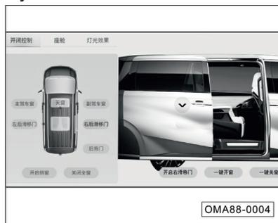
Когда питание автомобиля включено и функция электропривода сдвижной двери активирована, нажмите в главном меню «3D модель автомобиля в интеллектуальной зоне» или в меню приложения «Мой автомобиль», чтобы перейти в интерфейс функции «Мой автомобиль». Нажмите «Открыть сдвижную дверь» или «Закрыть сдвижную дверь», и сдвижная дверь автоматически откроется или закроется.
