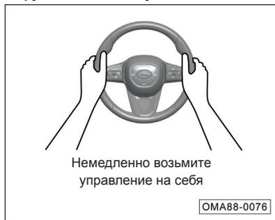
Когда система ICA обнаруживает, что руки водителя долгое время отсутствуют на рулевом колесе, она попросит водителя взять на себя рулевое управление. Над индикатором ICA замигают две стрелки и появится текстовое сообщение. Если водитель все же не возьмет управление на себя, предупреждение усилится, и на комбинированном индикаторе появится приведенное выше изображение, сопровождаемое звуковым сигналом, а в некоторых моделях также включится предупреждение в виде вибрации сиденья.
